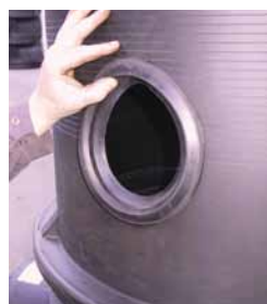
Reinigung und Schmierung des Randes
