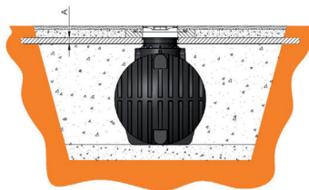
Slika: Montaža lovilca pod povozne površine
