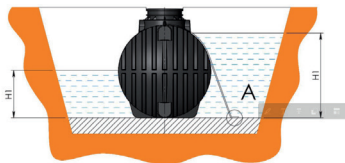
Bild: Abscheider Aufstellung bei Grundwasser
