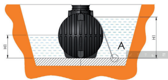
Slika: Postavitev lovilca v primeru podtalne vode
