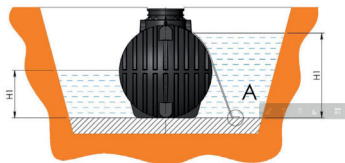
Slika: Ugradnja presretača u slučaju podzemnih voda
