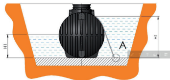
Slika: Postavitev lovilca v primeru podtalne vode
