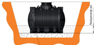
Slika: Postavljanje i zasipanje presretača
