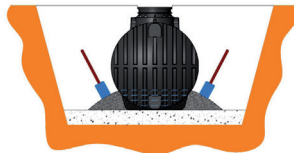
Bild: Verdichtung des leeren Raumes unter dem Abscheider
