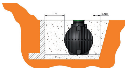
Slika: Montaža spremnika na nestabilnim padinama
