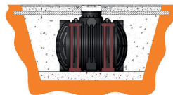
Slika: Podupiranje spremnika pomoću oplata i potpornih stupova
