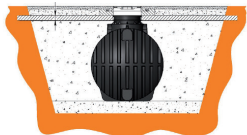
Slika: Postavljanje spremnika ispod vozne površine
