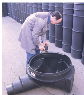
Odrez in čiščenje tehnološkega roba
