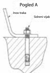
Slika: Detalj priključka INOX trakom
