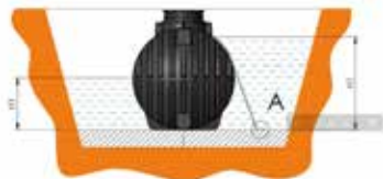
Slika: Ugradnja presretača u slučaju podzemnih voda
